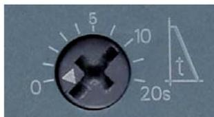
Время останова может устанавливаться на потенциометре  $t$ . Настоящим определяется, как долго еще необходимо подавать напряжение на двигатель после сброса команды пуска. В течение этого времени производимый двигателем момент уменьшается при помощи линейно изменяющегося напряжения и двигатель с нагрузкой плавно останавливается.
