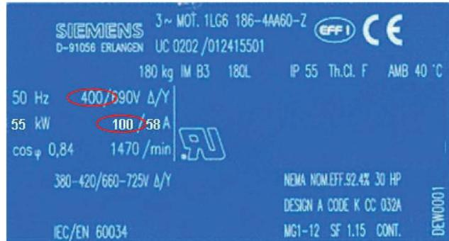
На потенциометре  $I_e$  необходимо установить номинальный рабочий ток двигателя согласно имеющемуся сетевому напряжению или типу подключения двигателя (звезда/треугольник). Электронная защита от перегрузки, если она включена, также настроена на это значение. Допустимые уставки относительно необходимого класса срабатывания по перегрузке двигателя, см. главу Уставки тока двигателя (Страница 126).
