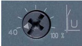
На потенциометре U устанавливается уровень пускового напряжения. Значение пускового напряжения определяет уровень момента вращения при включении двигателя. Уменьшенное пусковое напряжение приводит к снижению начального пускового момента (более плавному пуску) и уменьшению пускового тока.
