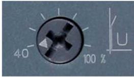
На потенциометре U устанавливается уровень пускового напряжения. Значение пускового напряжения определяет пусковой момент при включении двигателя. Уменьшенное пусковое напряжение приводит к снижению начального пускового момента (более плавному пуску) и уменьшению пускового тока.
