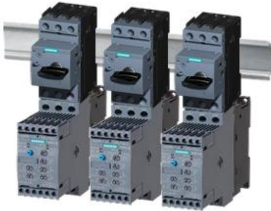
Если описанное в главе Монтажные размеры, размеры зазоров и вид монтажа (Страница 72) расстояние  $b$  вверх мало, когда, например, устройство плавного пуска устанавливается над соединительным модулем (напр., 3RV29) непосредственно на силовой выключатель (напр., 3RV2), то говорят о прямом монтаже.
