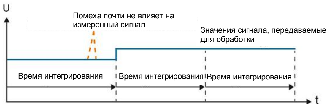
Иллюстрация 8-6 Помеха сильно влияет на мгновенное значение сигнала, в то время как на интегральное значение сигнала почти не влияет.
