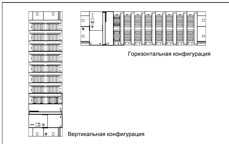
Рис. 2–1. Горизонтальная и вертикальная конфигурация ET 200M
